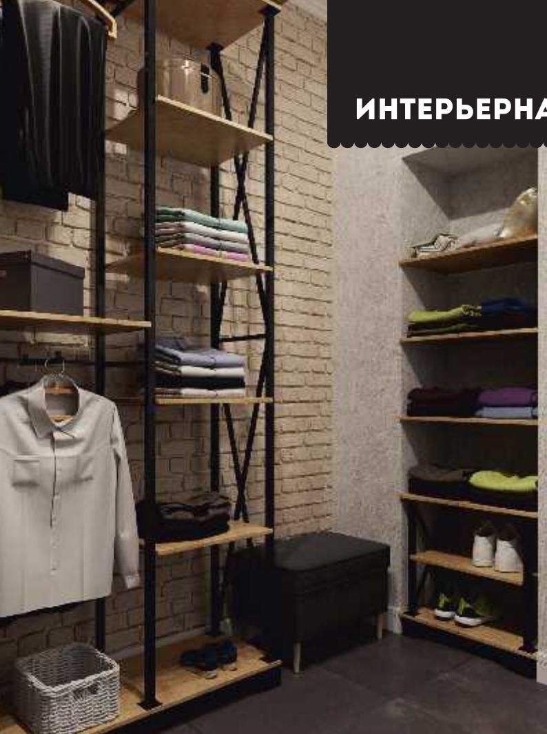
Система **CAGE** (Кейдж) – универсальная стеллажная система в классическом стиле, выполненная на квадратной трубе. Отличительной особенностью данной системы является наличие боковой перфорации. Система имеет декоративные пандус и фриз. С боков для жесткости конструкции стойки имеют перекрестья. Применение фрезерованных полок и скрытых полкодержателей позволяет придать всей конструкции строгий лаконичный вид. Данная система хорошо будет выглядеть в любом интерьере.
